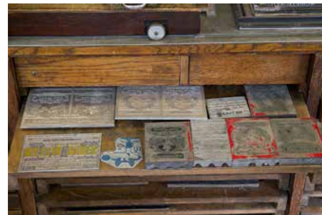
Klišei - delovi štamparskih formi u olovnom slogu za umnožavanje ilustracija
